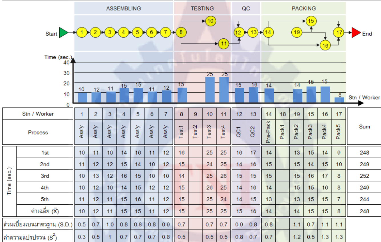
รูปที่ 22 แสดงกระบวนการ กราฟ และตารางข้อมูลหลังทำการปรับปรุง
