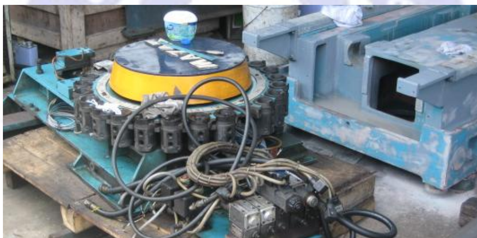
รูปที่ 19 การถอดชิ้นส่วนออกเพื่อทำความสะอาดและตกแต่ง
