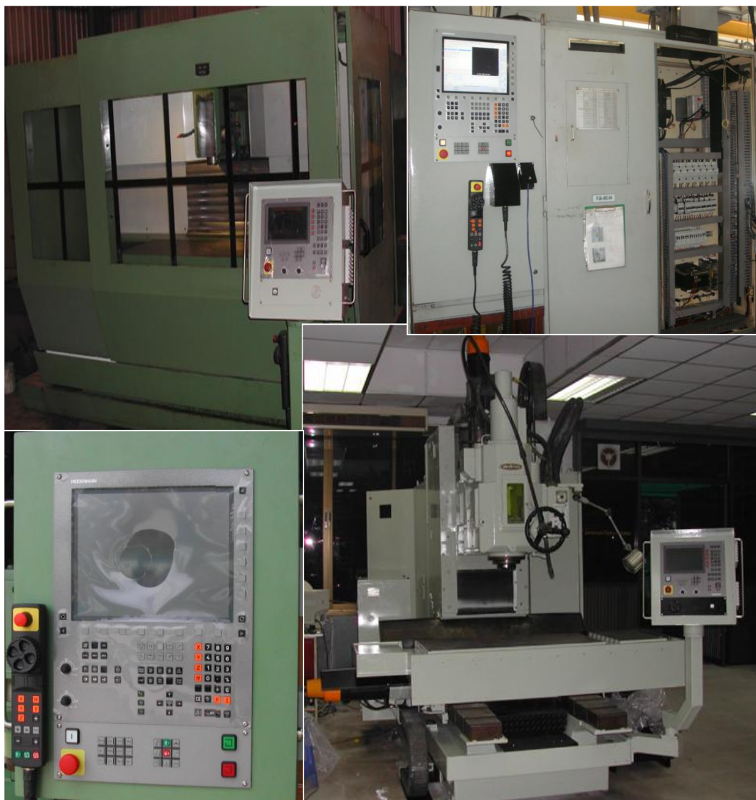
รูปที่ 30 เครื่องเวอร์ตคอลลแมชชีนนิ่งเซ็นเตอร์ที่ผ่านการรีโทรฟิต โดย บริษัท ซี.เอ็น.ซี. รีโทรฟิต แอนด์ เซอร์วิส จำกัด ร่วมกับ บริษัท ไฮเดนฮาน (ไทยแลนด์) จำกัด (ต่อ)
