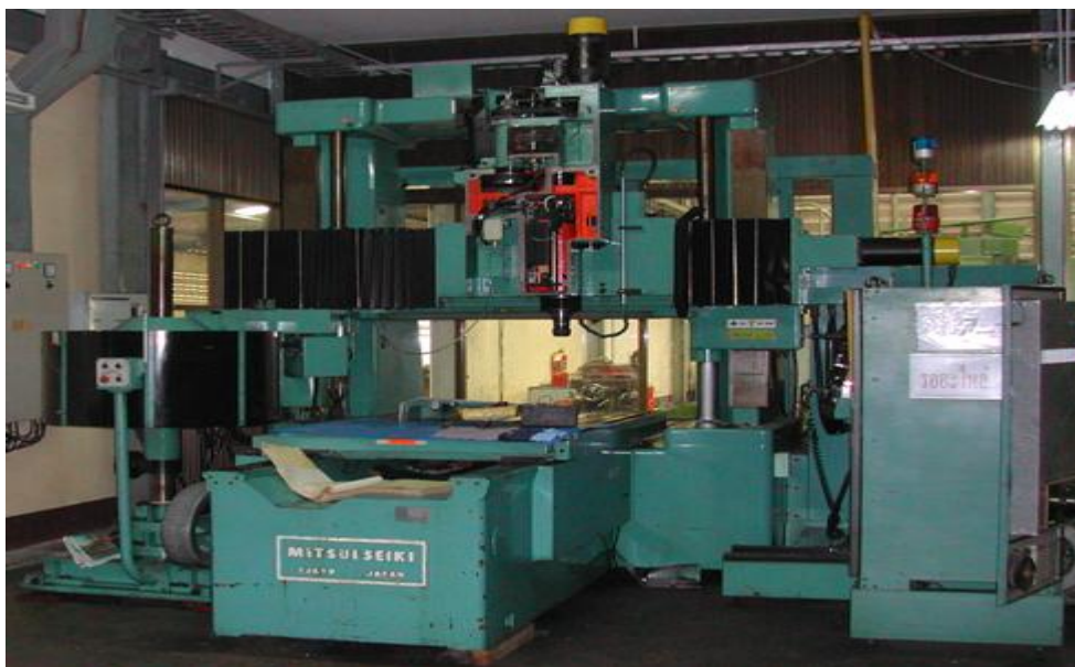
รูปที่ 12 เครื่องเวอร์ตคอลลแมชชีนนิ่งเซ็นเตอร์ก่อนที่จะรีโทรฟิตแบบพื้นฐาน
