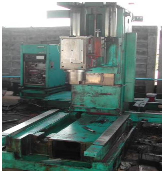
รูปที่ 18 เครื่องจักรเวอร์ติคอลลแมชชีนนิ่งเซ็นเตอร์ที่จะรีโทรฟิต
