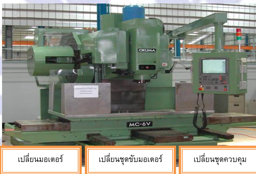
รูปที่ 15 เครื่องเวอร์ติคอลแมชชีนนิ่งเซ็นเตอร์หลังการรีโทรฟิตแบบกึ่งสมบูรณ์โดย บริษัท ซี.เอ็น.ซี. รีโทรฟิต แอนด์ เซอร์วิส จำกัด ร่วมกับ บริษัท ไฮเดนฮาน (ไทยแลนด์) จำกัด
