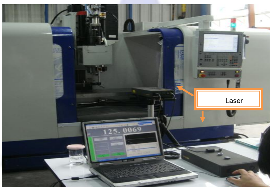
รูปที่ 25 การทดสอบความเที่ยงตรงด้วยเครื่องเลเซอร์ (Accuracy Laser Test)
