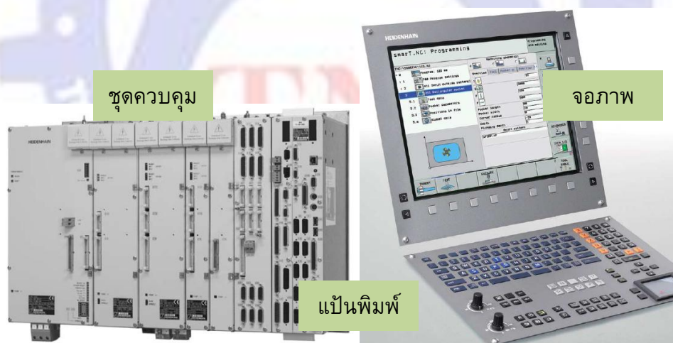
รูปที่ 4 ชุดควบคุม จอภาพ แป้นพิมพ์และสวิตช์ต่างๆ
