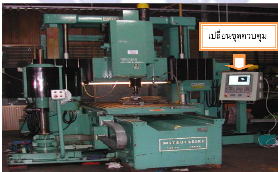
รูปที่ 13 เครื่องเวอร์ตคอลลแมชชีนนิ่งเซ็นเตอร์ที่ผ่านการรีโทรฟิตแบบพื้นฐานโดย บริษัท ซี.เอ็น.ซี. รีโทรฟิต แอนด์ เซอร์วิส จำกัด ร่วมกับ บริษัท ไฮเดนฮาน (ไทยแลนด์) จำกัด
