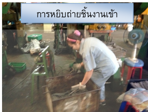
รูปที่ 37 การเคลื่อนไหวที่สูญเปล่าจากการหยิบถ่ายชิ้นงาน เข้า-ออก กระบวนการผลิต
