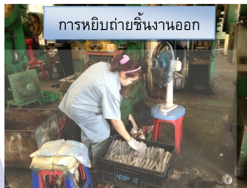
รูปที่ 37 การเคลื่อนไหวที่สูญเปล่าจากการหยิบถ่ายชิ้นงาน เข้า-ออก กระบวนการผลิต
