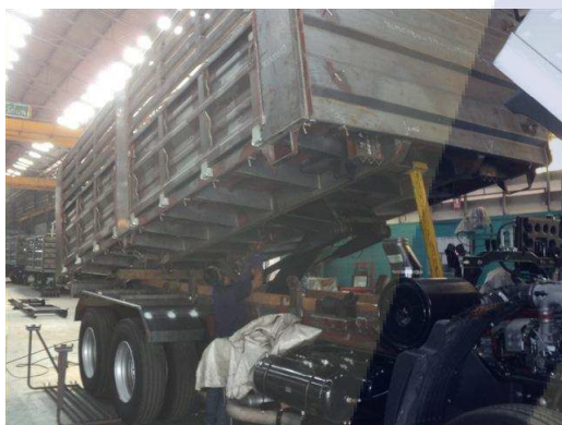
รูปที่ 56 การติดตั้งกระบอกระบบ Hydraulic ก่อนปรับปรุง
