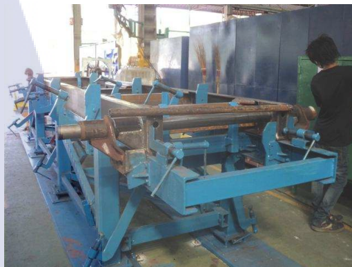
รูปที่ 54 การเชื่อมจุดหมุน หลังปรับปรุง
