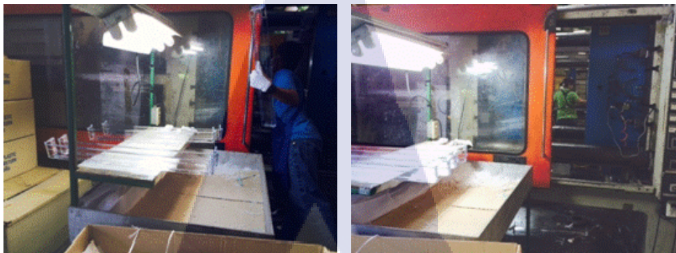
รูปที่ 27 พนักงานนำชิ้นงานที่ฉีดเสร็จแล้วออกมาจากแม่พิมพ์
