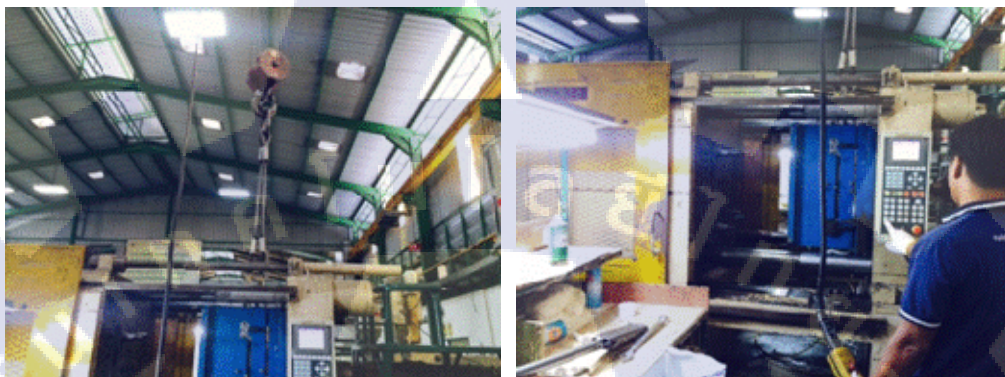
รูปที่ 23 ช่างนำแม่พิมพ์ติดตั้งกับเครื่องฉีด
