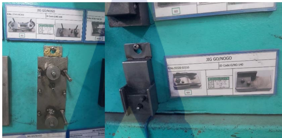
รูปที่ 45 จิกสำหรับตรวจสอบนัทเยื้องศูนย์กลางหลังการเชื่อม
