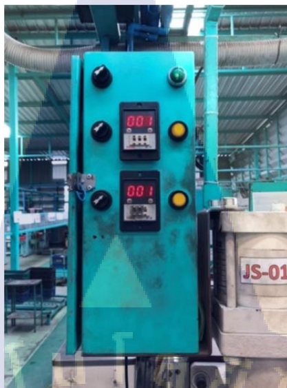
รูปที่ 51 ติดตั้งไฟสัญญาณเตือนครบจำนวนครั้งในการเชื่อม
