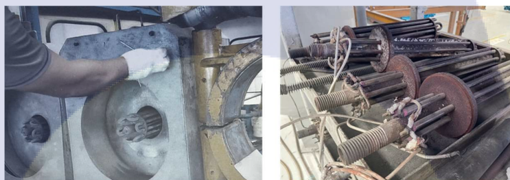
รูปที่ 19 การถอดฝาเตาอบและไส้ในของ Heater
