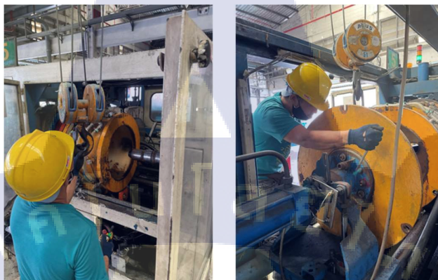
รูปที่ 12 การถอดหัวแบบชุดเก่าออกจากเครื่อง
