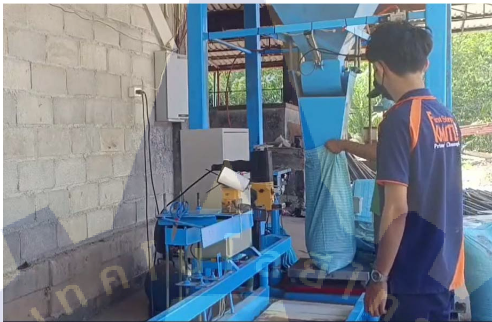
รูปที่ 18 การใช้งานถังบรรจุ แทนการใช้สกรูป้อนเข้ากระสอบ
