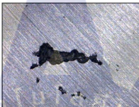
รูปที่ 13 ตัวอย่างของโพรงหดตัว (Shrinkage Porosity)
