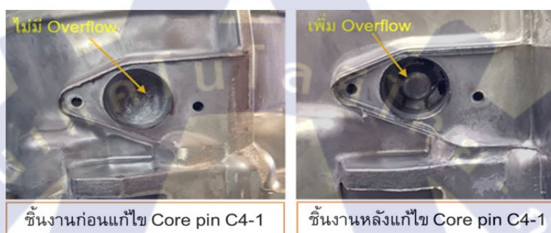
รูปที่ 29 เปรียบเทียบชิ้นงานจริงก่อนแก้ไขและหลังแก้ไขคอร์พิน
