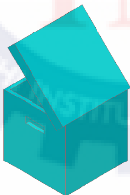
รูปที่ 15 กล่องลูกฟูกแบบฝาครอบในตัว แบบที่ 2
