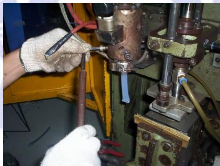
รูปที่ 14 การปรับแต่งการไหลของพลาสติก
