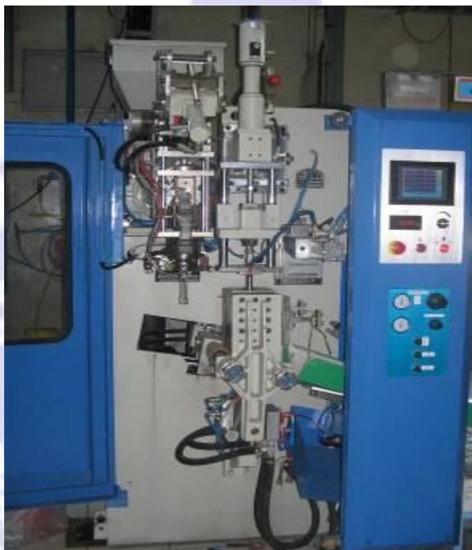
รูปที่ 9 เครื่องจักรเป่าขึ้นรูปบรรจุภัณฑ์พลาสติก
