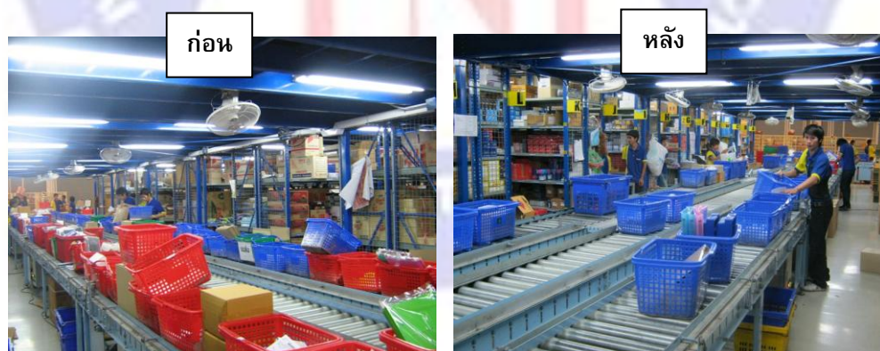
รูปที่ 63 จำนวน WIP ที่วางบนราง ก่อน-หลังการปรับ
