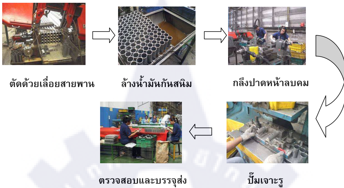
รูปที่ 13 กระบวนการผลิตท่อ Discharge ของคอมเพรสเซอร์
