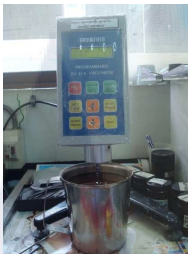
รูปที่ 32 แสดงการวัดค่าความหนืดของ Medium
