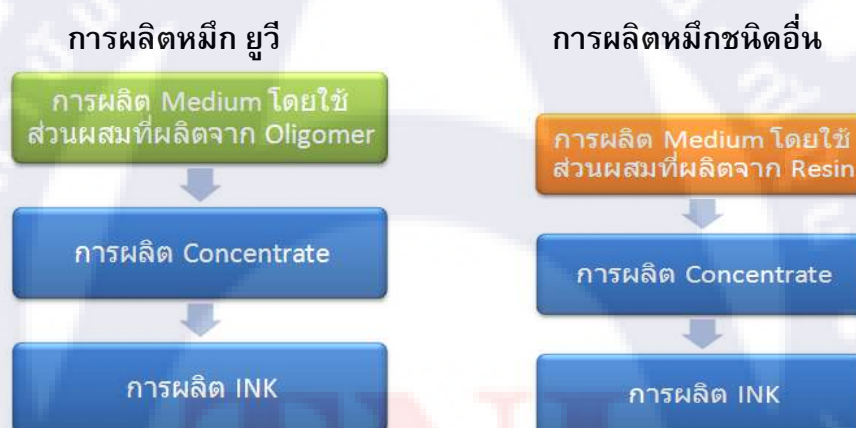
รูปที่ 30 แสดงความแตกต่างของกระบวนการผลิตและวัตถุดิบสำหรับการผลิตหมึกพิมพ์ ชนิดยูวี กับหมึกพิมพ์ชนิดอื่นๆ
