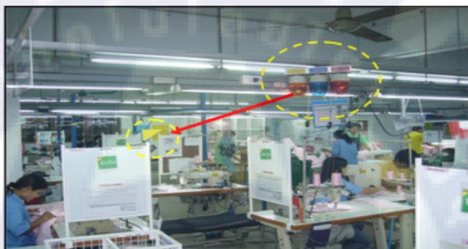
รูปที่ 12 แสดงการติดตั้งไฟอันดงที่ไลน์เย็บผ้า
