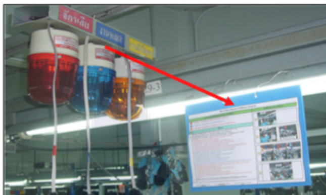
รูปที่ 5 ตัวอย่างไฟอันดงที่แสดงสถานะความผิดปกติของสายการผลิต
