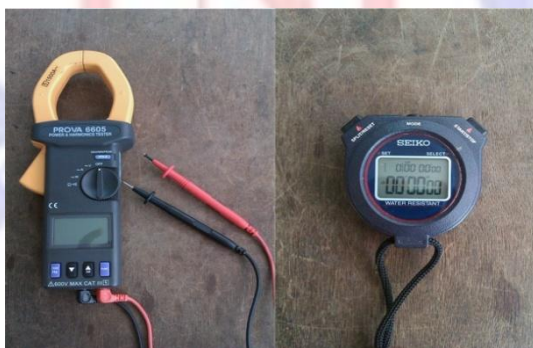
รูปที่ 1 คลิปปอนกิโลวัตต์ และนาฬิกาจับเวลา เครื่องมือในการตรวจสอบมิเตอร์
