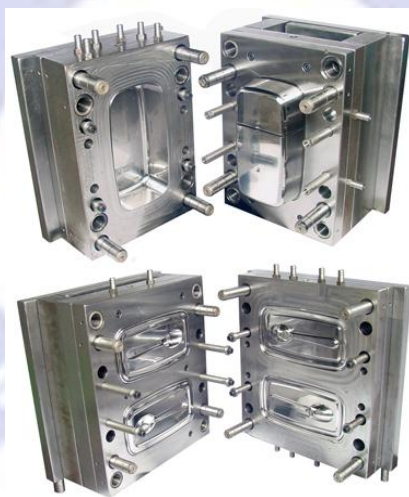
รูปที่ 2 แม่พิมพ์ชิ้นงานเดียว และแม่พิมพ์หลายชิ้นงาน
