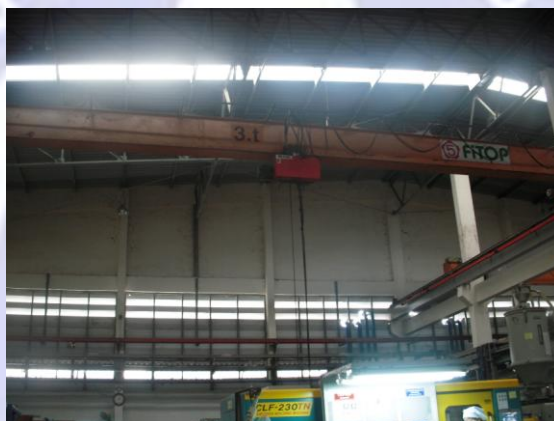
รูปที่ 8 เครนขนาด 3 ตันบริเวณเครื่องฉีดที่ใช้ในการศึกษา
