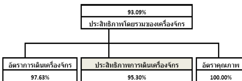
รูปที่ 7 แผนผัง OEE กระบวนการผลิตของบริษัท ตัวอย่าง จำกัด ก่อนปรับปรุง
