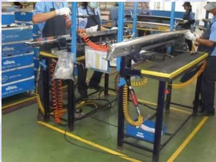
รูปที่ 31 กิจกรรมไคเซ็น : ออกแบบโต๊ะให้สามารถหมุนพลิกชิ้นงานได้
