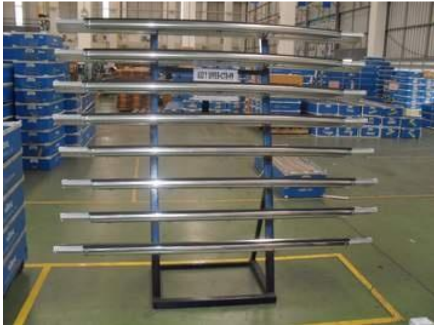
รูปที่ 32 กิจกรรมไคเซ็น : ลดจำนวน WIP ให้เท่ากับหนึ่งคัมบัง
