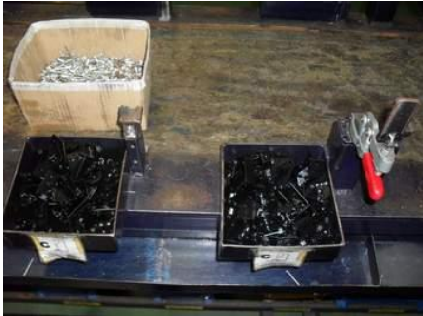
รูปที่ 30 กิจกรรมไคเซ็น : ลดจำนวน Toggle Clamp โดยใช้ Stopper แทน
