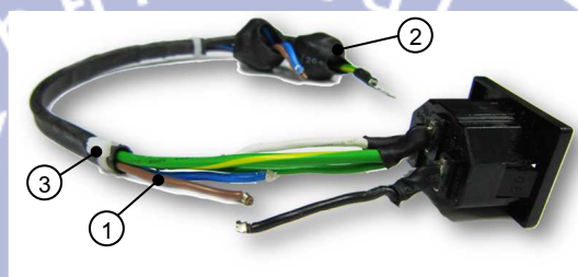
รูปที่ 17 ชุดสายไฟกระแสเข้า (Input Cable) หลังทำการปรับปรุง
