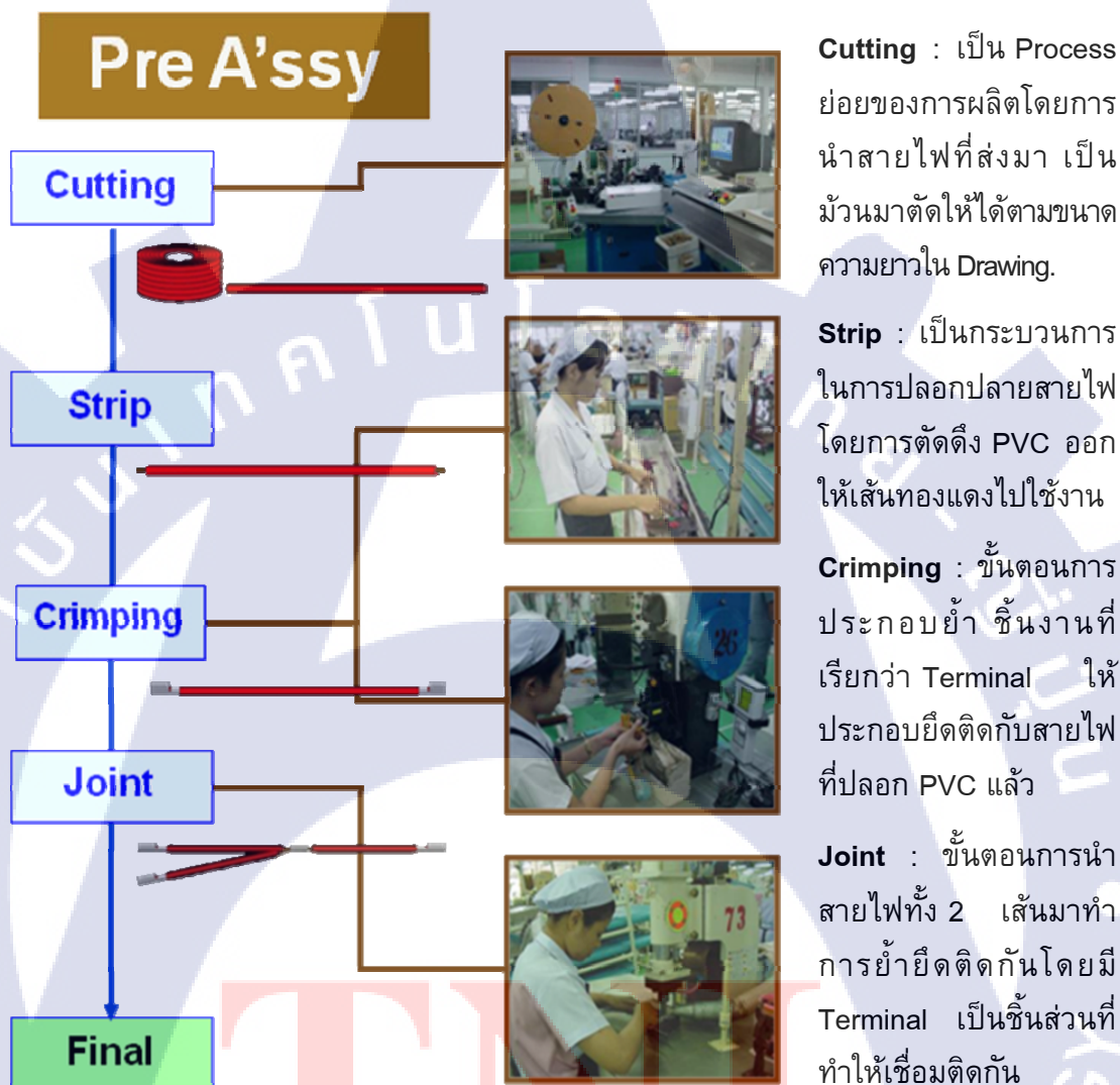
รูปที่ 5 กระบวนการผลิตสายไฟ แผนก Pre Assembly
