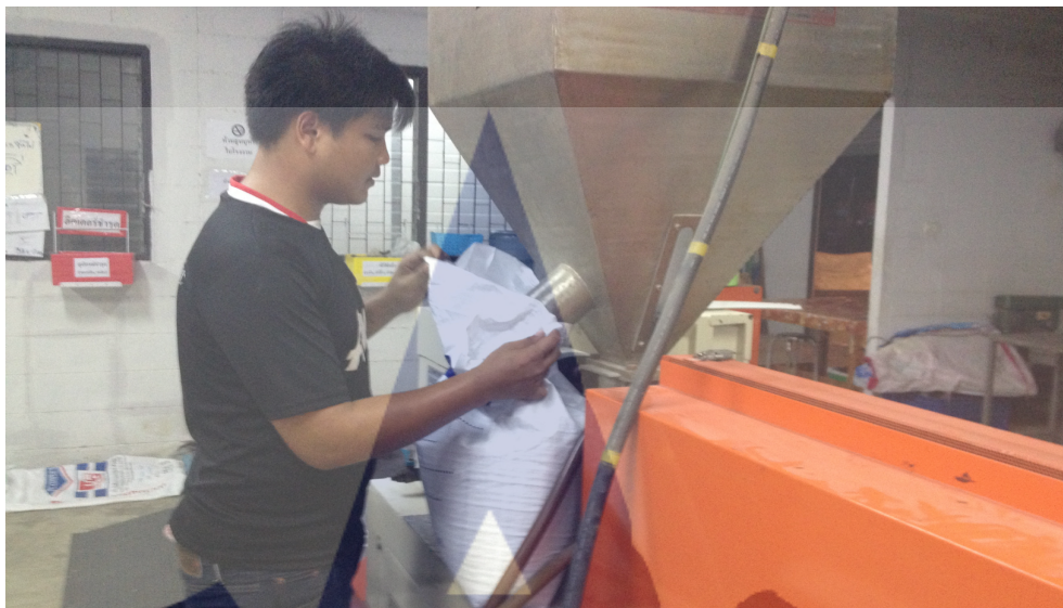
รูปที่ 17 การถ่ายวัสดุออกจาก Hopper
