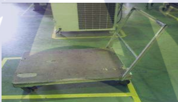
รูปที่ 12 รถเข็นสำหรับลำเลียงแม่พิมพ์
