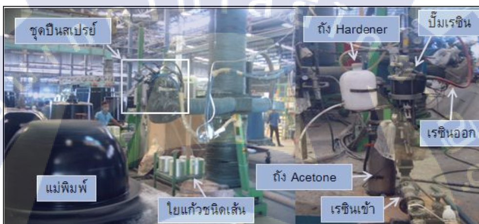
รูปที่ 10 เครื่องพ่นโพลีเอสเทอร์เรซินผสมใยแก้ว (Spray-up)
