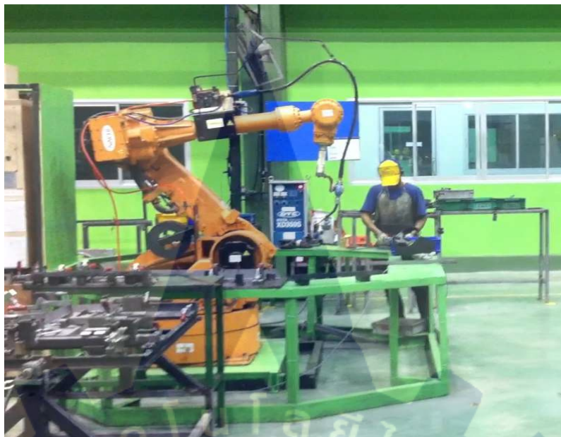
รูปที่ 16 ขั้นตอนกระบวนการเชื่อมประกอบชิ้นงาน
