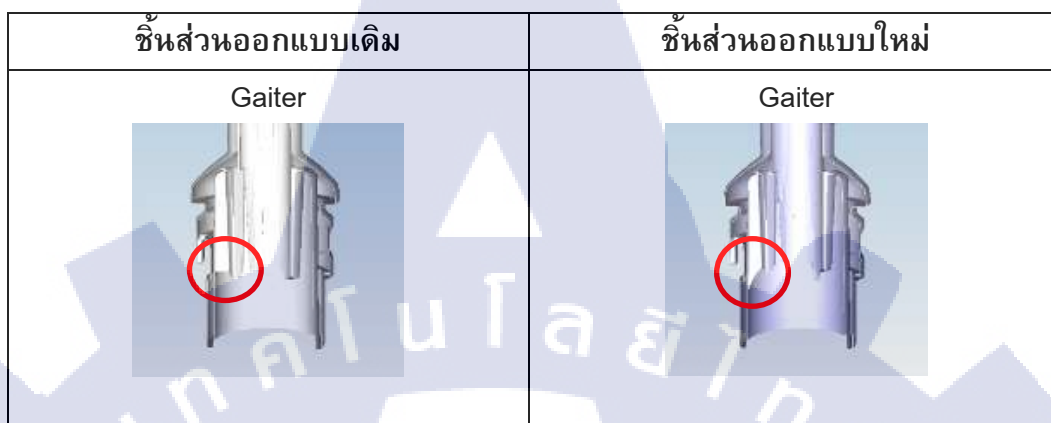
รูปที่ 14 ความแตกต่างของรูปทรงครีปของ Gaiter ของชิ้นส่วนเดิม และใหม่
