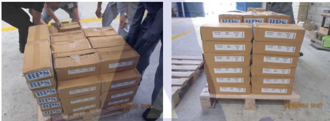
รูปที่ 17 ขาพาเลทไม้ทดลองวางขึ้นงาน 1 ตัน
