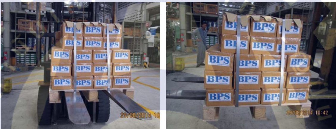
รูปที่ 17 ขาพาเลทไม้ทดลองวางขึ้นงาน 1 ตัน
