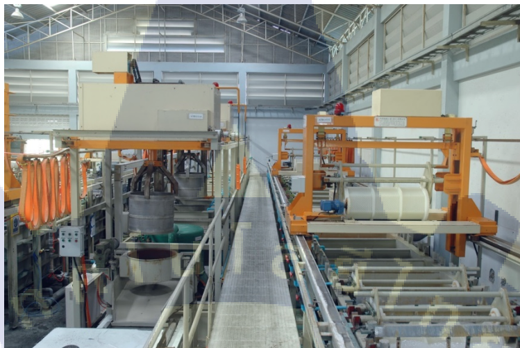
รูปที่ 27 เครื่องจักรระบบอัตโนมัติสำหรับผลิตชิ้นงานชุบโลหะด้วยไฟฟ้าชนิดสังกะสีแบบถังกลิ้ง ของโรงงานที่ 1
