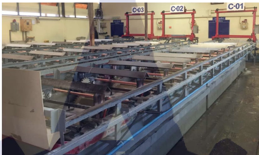
รูปที่ 20 เครื่องชุบโลหะด้วยไฟฟ้าชนิดสังกะสี รหัสเครื่อง C-1 C-2 และ C-3
