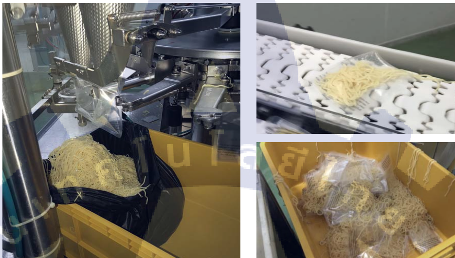
รูปที่ 30 ลักษณะปัญหาหน้างานจริงที่เกิดขึ้นในขั้นตอนการบรรจุเส้นในถุงบรรจุ
