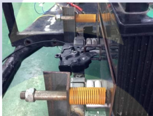
รูปที่ 4.5 ระบบล็อกแบตเตอรี่ขณะที่ถูกล็อก
