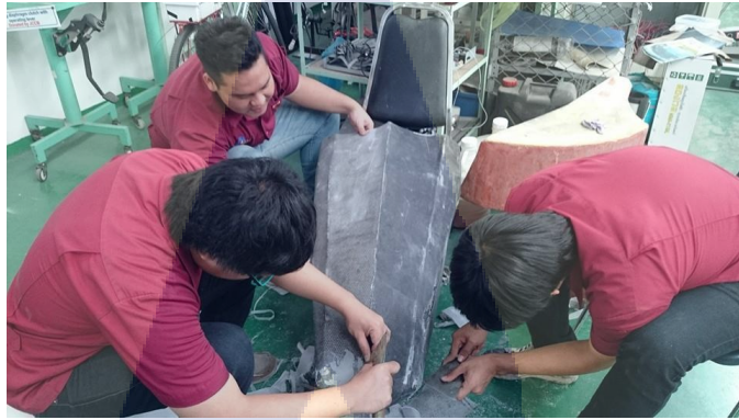
รูปที่ 4.17 การดึงผ้าลอกลาย Body ส่วนหัวรถหลังจากทำการ Vacuum มา
