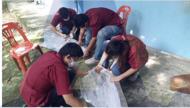
รูปที่ 4.14 การขัดผิวโมลให้เรียบก่อนนำไปขึ้นรูป Body ส่วนหัว
