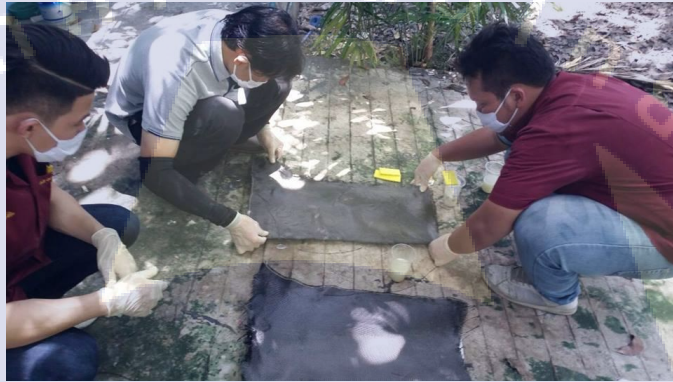
รูปที่ 4.18 ทาหน้ายาเรซินลงผ้าคาร์บอนกับโมลของ Body ก่อนนำไป Vacuum
