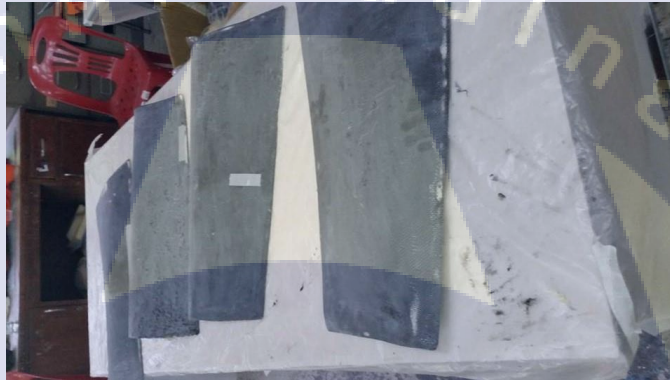
รูปที่ 4.21 Body ส่วนด้านข้างของรถหลังจาก Vacuum เสร็จ
