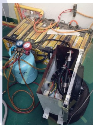
รูปที่ 4.8 ภาพแสดงการชาร์จน้ำยาทำความเย็นเข้า คอมเพรสเซอร์
