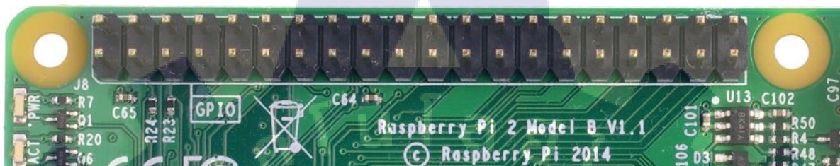
รูปที่ 3.4 GPIO Pins บนอุปกรณ์ Raspberry Pi
