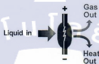
รูปที่ 1.1 หลักการผลิตก๊าซเชื้อเพลิงด้วยวิธีพลาสมาอาร์ค
