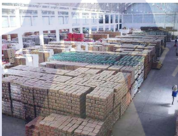
รูปที่ 1 การวางสินค้าแบบ Block Stacking
