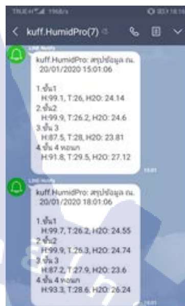
รูปที่ 4.7 แสดงการทำงานของระบบ (1) บน Android App. และ (2) แจ้งเตือนผ่าน Line App.
