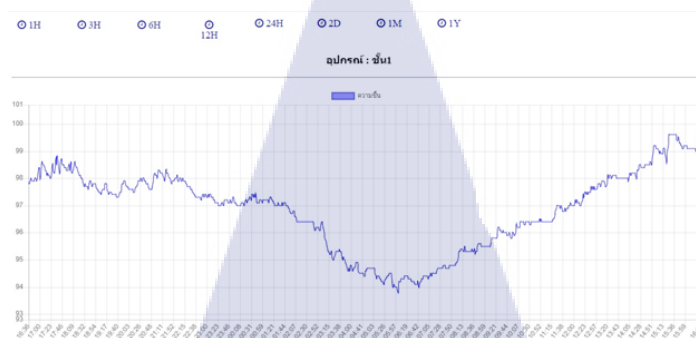
รูปที่ 4.3 แสดงกราฟความชื้นของชั้นที่ 1 ภายในอาคารฟาร์มนกแอ่นกินรัง (12 ชั่วโมง) โดยระบบสามารถเลือกการแสดงผลได้ตั้งแต่ 1 ชั่วโมง จนถึง 1 ปี
