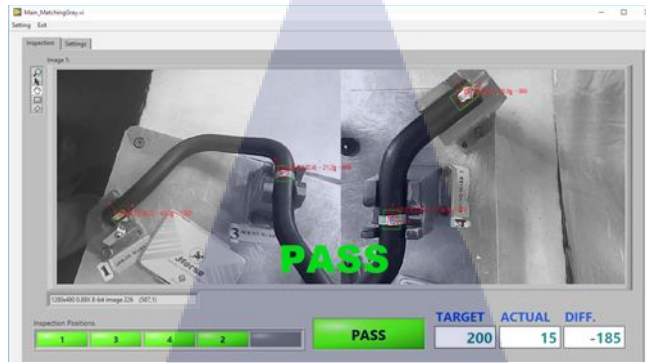
รูปที่ 5.11 ตัวอย่างโปรแกรมตรวจวัดชิ้นงานแบบ 5 ตำแหน่งที่ชิ้นงานทำสัญลักษณ์ครบ
