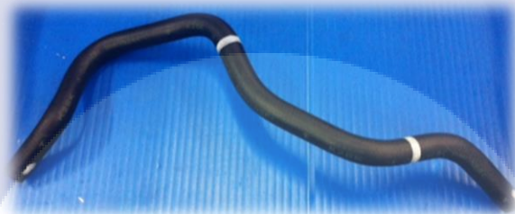
รูปที่ 5.2 ตัวอย่างท่อไฮดรอลิกและตำแหน่งที่ทำสัญลักษณ์ครบ
