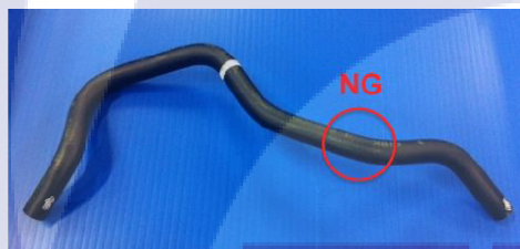
รูปที่ II ท่อไฮโดรลิกที่ทำสัญลักษณ์ไม่ครบ
