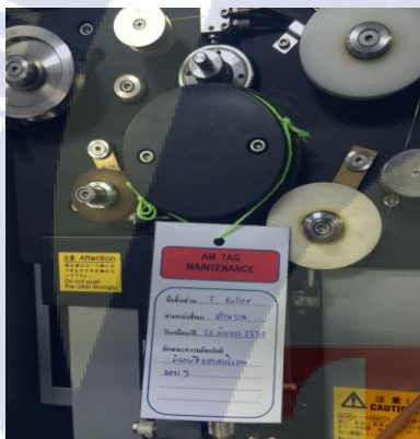
รูปที่ 5 ตัวอย่างการติด Tag ที่ Roller
