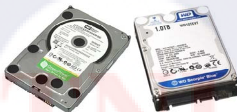
รูปที่ 18 ผลิตภัณฑ์ฮาร์ดดิสก์ไดรฟ์ขนาด 3.5 นิ้ว และขนาด 2.5 นิ้ว
