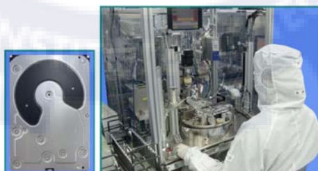
รูปที่ 60 แสดงเครื่องประกอบฝาปิด (Auto Topcover m/c)
