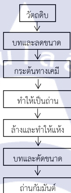
รูปที่ 2.7 ขั้นตอนการผลิตถ่านกัมมันต์ด้วยวิธีการกระตุ้นทางเคมี
