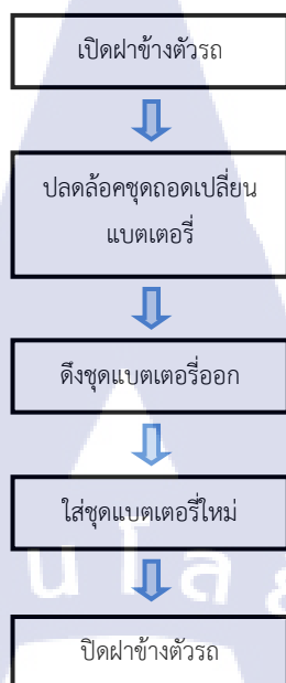
รูปที่ 4.11 ขั้นตอนการทำงานของ การถอดเปลี่ยนแบตเตอรี่
