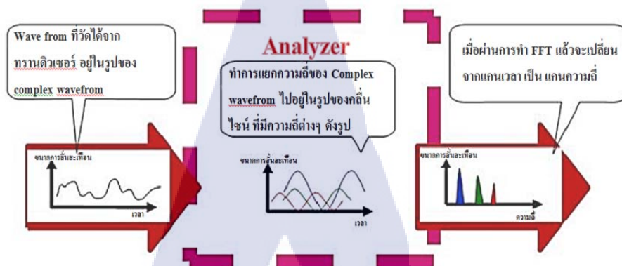
รูปที่ 2.47 หลักการทำงานของ Fast Fourier Transform
