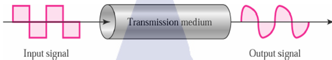
รูปที่ 2.28 แนวคิดของความเพี้ยนของสัญญาณที่ฝั่งด้านรับ (Output Signal) จากสัญญาณที่ฝั่งด้านส่ง (Input Signal)
