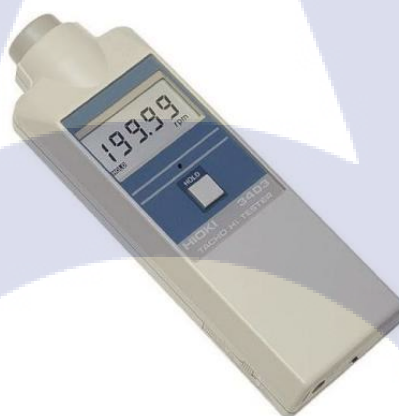
รูปที่ 3.7 อุปกรณ์วัดความเร็วรอบของมอเตอร์ (HIOKI 3403)
