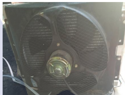
รูปที่ 3.9 พัดลมสำหรับระบายความร้อนจากคอยล์ร้อน ขนาด 12" แรงดันไฟฟ้า 24 Volt 90 Watt
