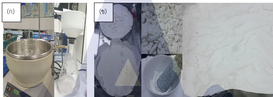
รูปที่ 3.4 (ก) อุปกรณ์ที่ใช้ในการละลายและตากตะกอน (ข) ตะกอนแคลเซียมคาร์บอเนตที่ผลิตได้
