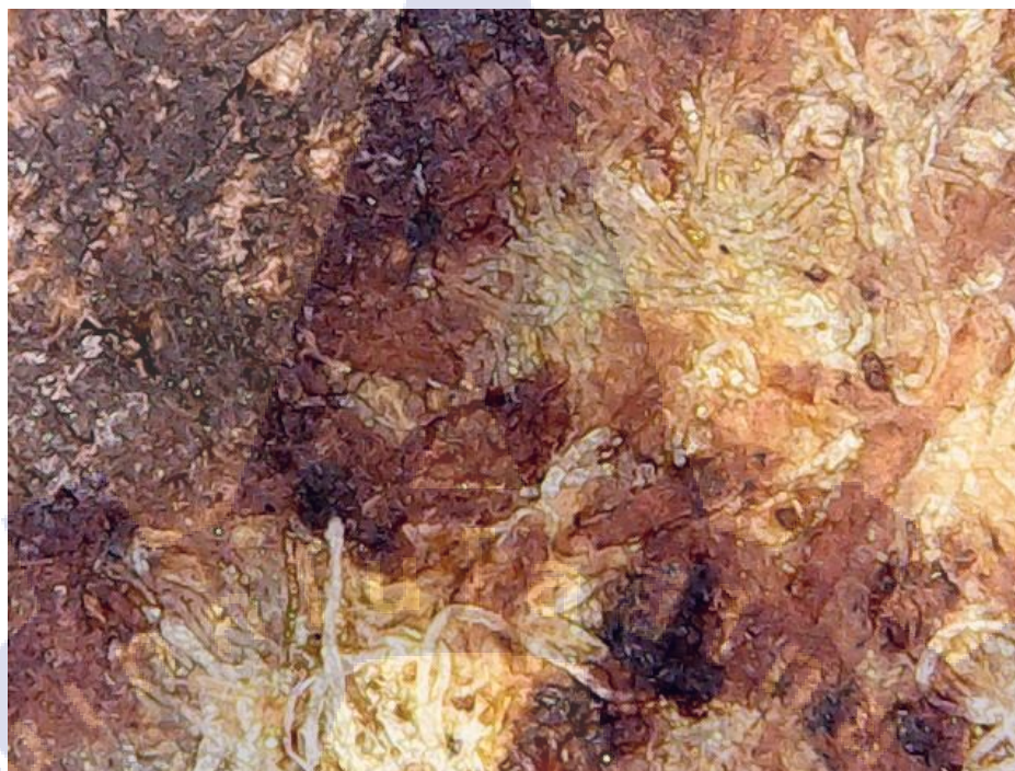
รูปที่ 4.20 ภาพถ่ายจากกล้องจุลทรรศน์ถ่านชีวภาพจากขี้เลื่อย 60% ต่อเศษผ้า 40% x1000 (TOP)
