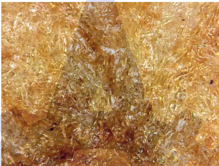
รูปที่ 4.14 ภาพถ่ายจากกล้องจุลทรรศน์ถ่านชีวภาพจากเศษผ้า 100% กำลังขยาย x1000 (TOP)
