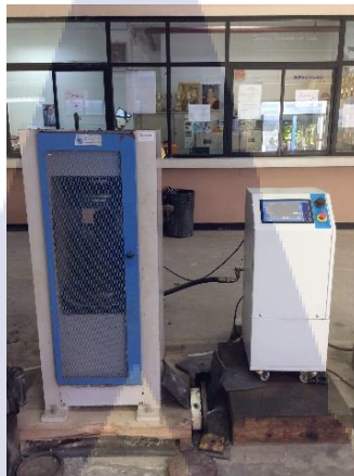
รูปที่ 2.3 ตัวอย่างเครื่อง Automatic Hydraulic pack ทดสอบค่าการทนแรงอัดสูงสุด [9]
