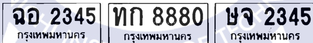
รูปที่ 4.5 ป้ายทะเบียนรถยนต์ประเภทต่างๆ หลังแปลงเป็นภาพขาวดำ และตัดส่วนที่ไม่เกี่ยวข้อง
