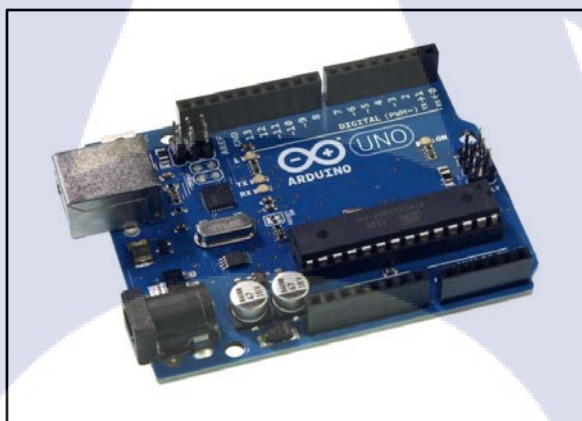
รูปที่ 2.17 Arduino รุ่น UNO R3
