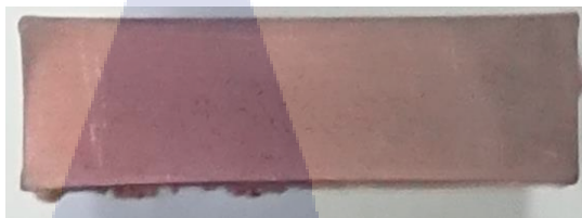
รูปที่ 4.7 สภาพผิวอิเล็กโทรดชุบด้วยเงินไซท์ที่ดีที่สุดหลังจากการกัดขึ้นงาน
