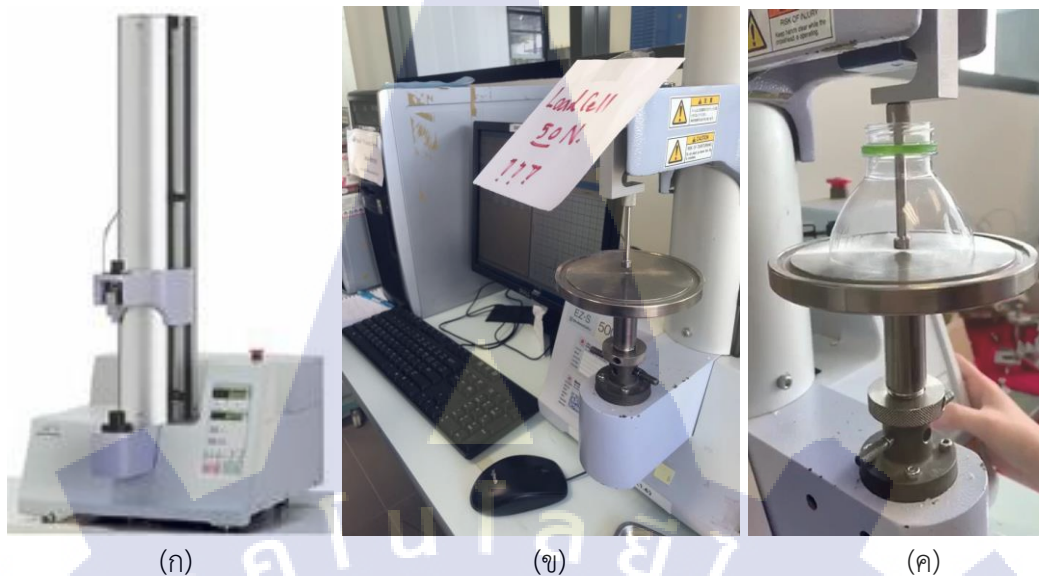
รูปที่ 3.10 (ก) เครื่องทดสอบแรงดึงแรงอัด (ข) การติดตั้งชุดอุปกรณ์หัวกดและฐานสำหรับทดสอบแรงดึงแรงอัด (ค) การทดสอบแรงอัด
